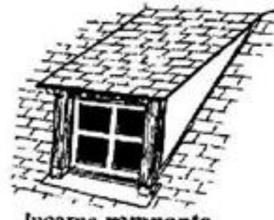
lucarne rampante ou en "chien couché"
